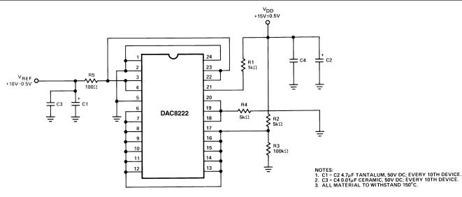
Figure 18. Burn-In Circuit
