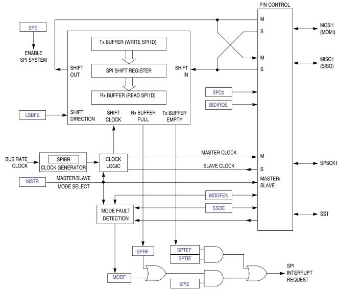
Figure 12-3. SPI Module Block Diagram
