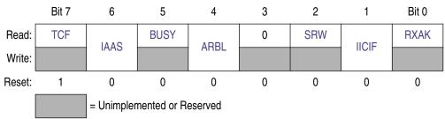
Figure 13-8. IIC Status Register (IIC1S)
