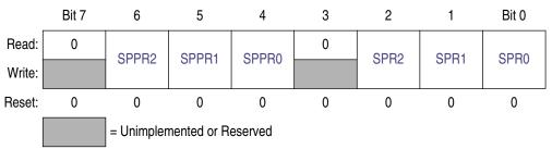
Figure 12-9. SPI Baud Rate Register (SPI1BR)
