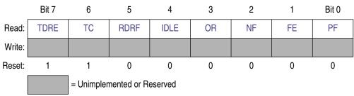
Figure 11-9. SCI x Status Register 1 (SCIxS1)
