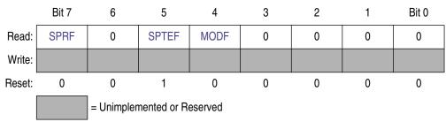
Figure 12-10. SPI Status Register (SPI1S)
