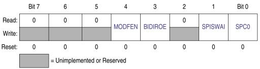
Figure 12-8. SPI Control Register 2 (SPI1C2)
