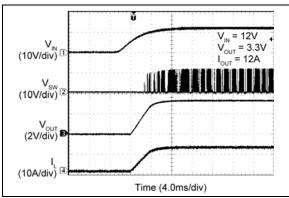
FIGURE 2-56: V<sub>IN</sub> Soft Turn-On.
